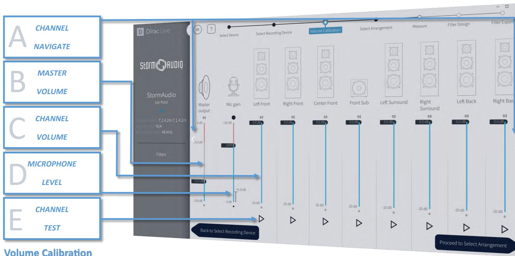
以下からはマイクによりリスニングルームの音響特性を測定します。音響特性の測定精度は、測定後適応される補正フィルターの設計を行う上で非常に重要です。ここでは正しい座席配置を選択する必要があります。対応する選択肢 (A) をクリックして、リスニング環境のプリセットを選択します。
