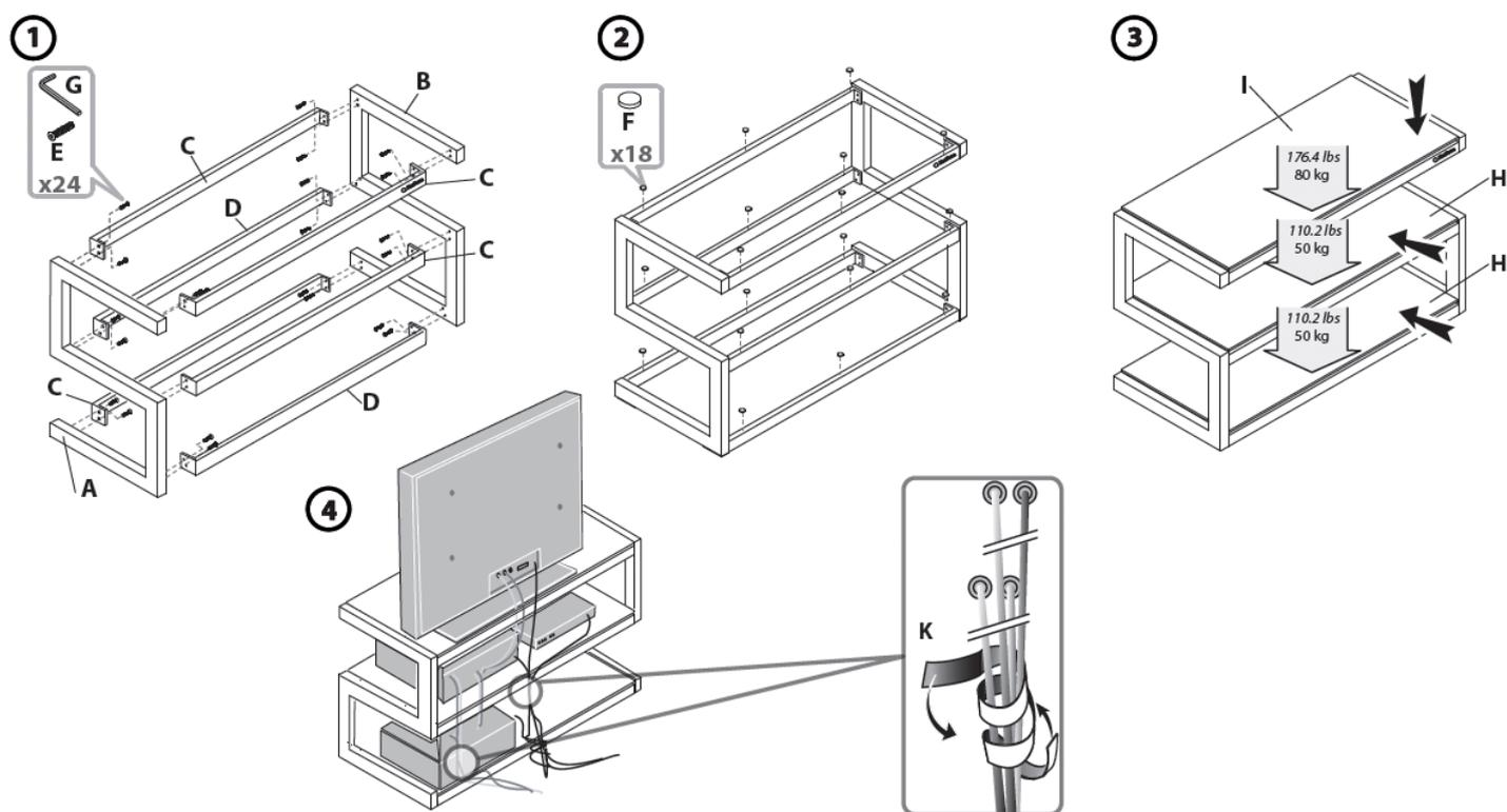
①サイドフレームとガラス受けフレームを付属のネジで、六角レンチを使用して固定します。ガラス受けのフレームはC、D2種類ありますので、御注意下さい。
