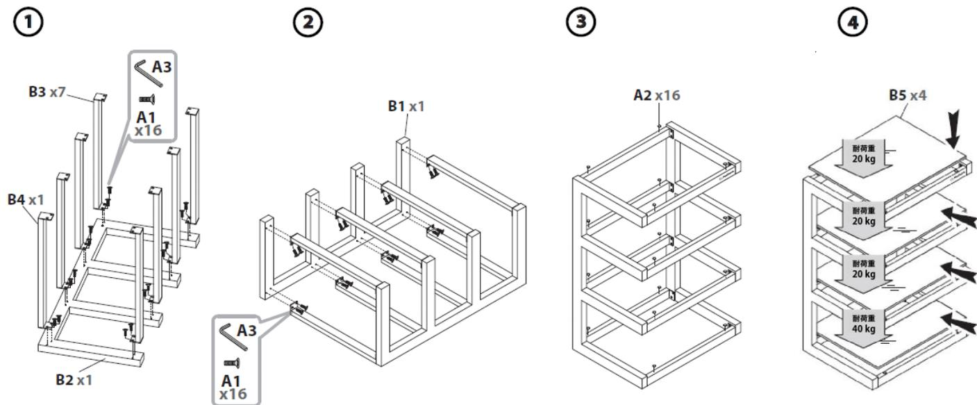
①サイドフレームを床に置いた状態で、ガラス受けフレームを付属のネジで、六角レンチを使用して固定します。1本だけ穴の位置が違うB4のフレームがありますので御注意下さい。また、B3フレームの1本にロゴ付の物がありますので、これを前面の一番上に来るようにします。
