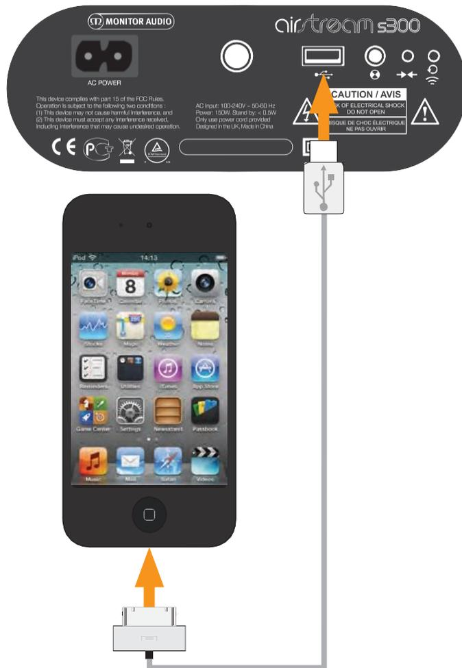
2. S300 の入力切替ボタン
