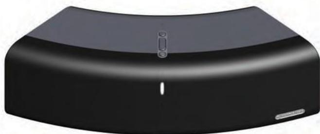
3. インフォメーション LED が白色に点灯したら、電源ボタンを放します。その後 S300 は、ファームウェアのアップデートプロセスに入り、インフォメーション LED は以下のように変化します。
