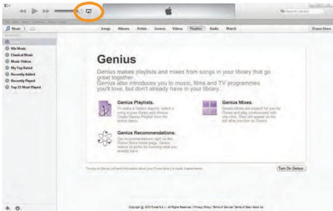
2. AirPlay のアイコンをクリックし、表示されるデバイスから S300 を選択してください。 AirPlay が出力先に選ばされると、アイコンはブルーに変化します。
