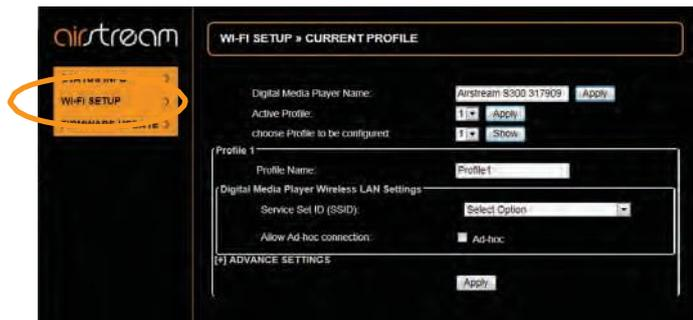
9. SSID のドロップダウンをクリックし、接続したい Wi-Fi ネットワークの SSID を選びます。
