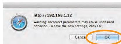
11. OK ボタンを押した後は、Web ブラウザーの表示は更新されません。 S300 のインフォメーション LED は、ネットワークに接続を試みる間、青色で点滅します。 ネットワーク接続が確立すると、S300 は直前の入力モードに戻ります。 AirPlay を選択するには、インフォメーション LED が青色の点灯となるように、入力切替ボタンを押してください。 もし、インフォメーション LED が、ゆっくりと赤色で点滅する場合は、ネットワークへの接続に失敗した状態を表します。 ステップ 9 で入力した SSID、暗号化キーに間違いがあった可能性があります。 この場合、お手数ですが、もう一度ステップ 1 からやり直してください。
