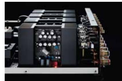
A35.8 の回路レイアウトは、電源ノイズを遮断するヒートシンクに収納されたアンプモジュールに、電源から最もダイレクトに電力を供給し、均一に分配する独創的な設計になっています。さらに、入力段と出力段をアンプモジュールから発生するノイズから隔離する革新的な構造となっています。入出力信号は、ヒートシンクの溝に通されたリボン状の回路基板を通してアンプモジュールに送られ、最短の信号経路を実現しています。
