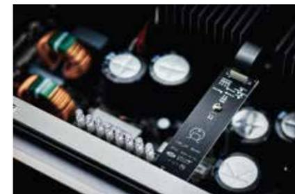
起動時、各アンプモジュールの底部にある8個の内部赤色LEDランプが点滅。また、クリッピング状態が発生すると、トップカバー越しに上方から確認できます。さらに、アンプ前面のトップカバーの下には、8個のLED警告システムがあり、次のような表示をします。
