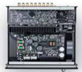
DAC ステージの心臓部には、ESS の特許取得済み HyperStream II アーキテクチャと Time Domain Jitter Eliminator を採用し、高い評価を得ている ES9026PRE が搭載されています。ES9026PRO 32 ビットオーディオ DAC は、前例のない最大 124dB の DNR と -110dB の THD+N を実現しています。SPA25 Prisma には 8ch の ESS9026PRE DAC チップをデュアルで実装しており、そのユニークな特徴としてフロント L/R 出力出力に 4ch を割り当てる独自の DA 変換回路により、ステレオ・パフォーマンスを向上させています。デジタルの入力は、オプティカル (Toslink) ×2、RCA (SPDIF) ×1、USB-B デジタル ×1。USB-B 入力では、PCM 768kHz/32bit、DSD 22.6MHz、DoP 11.2MHz までのファイルを再生できます。
