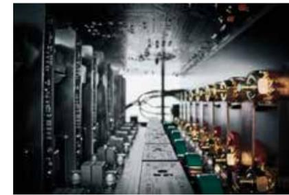
アンプ部には Hypex UCD250LP パワー・テクノロジーを採用し、即効性と持続性のある高出力を実現。主な特徴は、負荷インピーダンスに関係なくフラットな周波数特性、非常に低い放射および伝導 EMI。スピーカー出力でのみフィードバックを受ける位相シフト制御の自己発振ループに基づいており、その結果、非常に低い歪み、瞬時の立ち上がり、リニアな増幅を実現し、自然なスピードとクリーンで俊敏なサウンドを生み出します。
