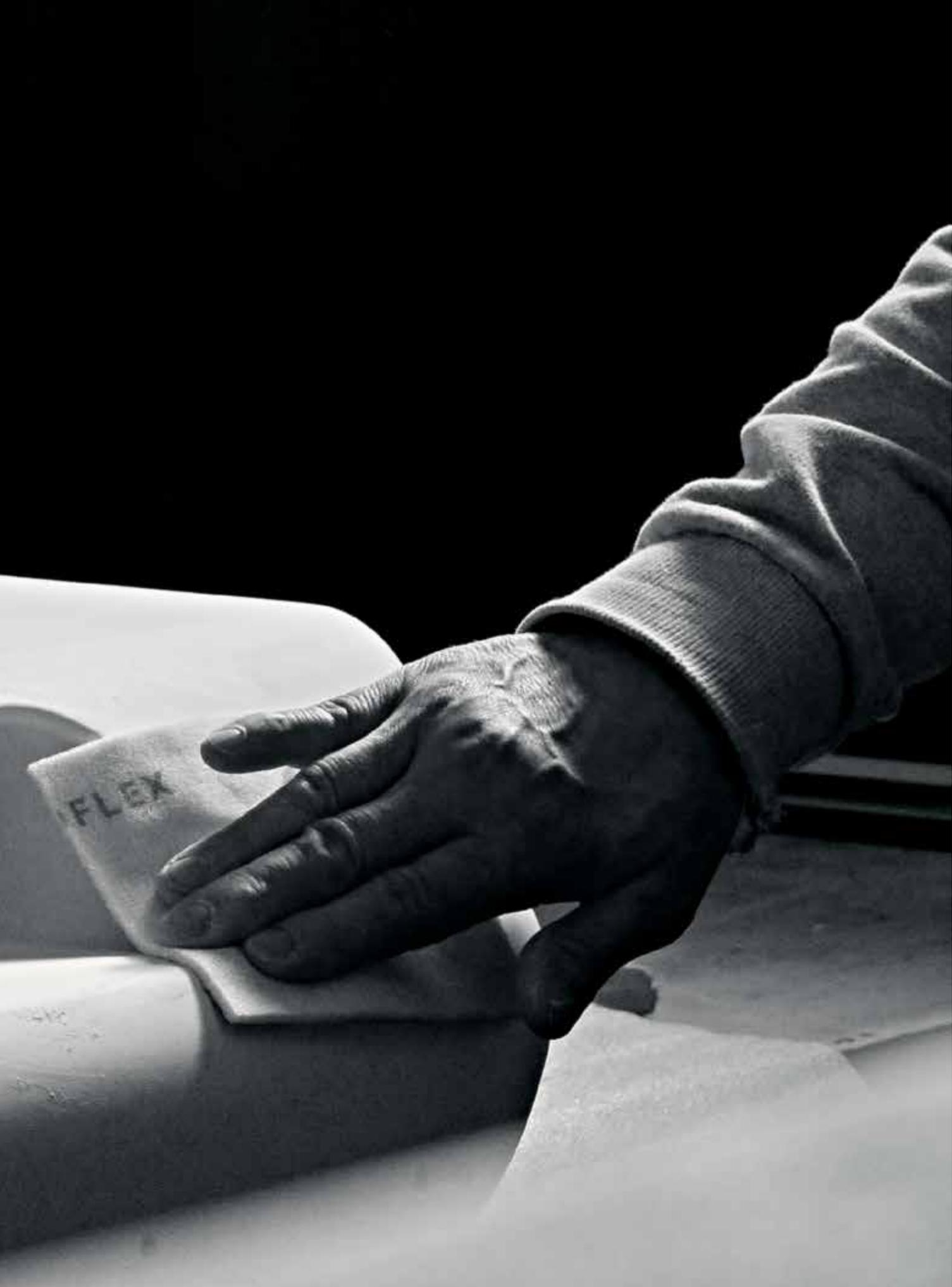
Hyphnの独特なキャビネットは、最高品質のソリッドサーフェス素材で作られています。長時間の研究とテストの結果、アクリル、鉱物、天然顔料を組み合わせた複合材料にたどり着きました。これにより、滑らかで見た目に継ぎ目のない表面を作り出し、Hyphnの印象的で特徴的なフォルムを作り出しています。アクリルストーンは、駆動ユニットがその驚くべき潜在能力をフルに発揮するための完璧な土台となっています。アクリルストーンはすぐれた剛性を持ち、かつ天然の不活性物質であるため非常にすぐれたダンピング能力を発揮し、ベース・キャビネットの中で不要な振動を発生させません。
