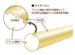
硫化銅の被膜層は、メッキ・コーティングではなく 化学結合されているため、水洗いしても剥離しません。そのため変質が無く除電効果も変わらないため、半永久的に使用可能です。
